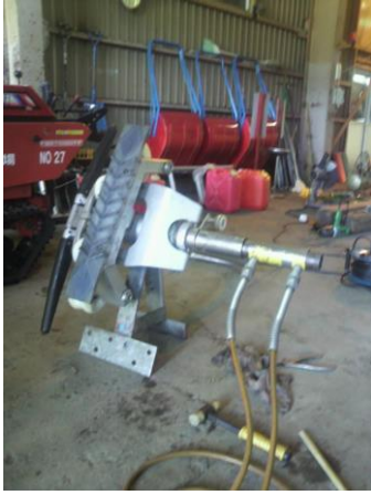
握索機分解点検(フライングキャットトリプル)
