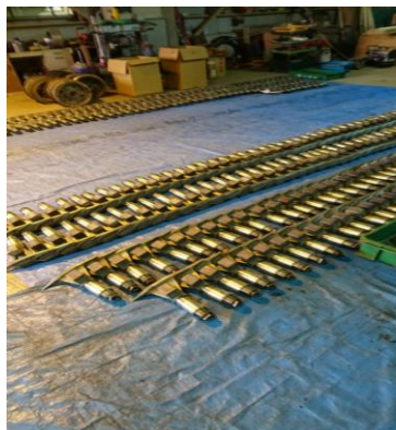
ロマンスリフト握索器分解点検整備
